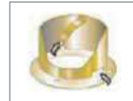
Oil Lifter กวนน้ำมันเพื่อหล่อลื่นซีล 2 ชั้น ทั้งบนและล่าง เพื่อยืดอายุการใช้งานของ Mech.Seal
