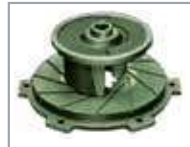
Non-clog Cutting Impeller ใบพัดตัดเส้นคาร์ไบด์ ติดตั้งเคียงกับ Suction Cover เพื่อให้เป็นกลไกตัดเศษวัสดุที่ติดมากับน้ำที่สูบน้ำ
